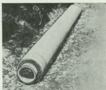
Rys. 8-4. Odcinek specjalnej rury azbesto-cementowej do transportu wody ciepliczej (Ragaz — Szwajcaria)
