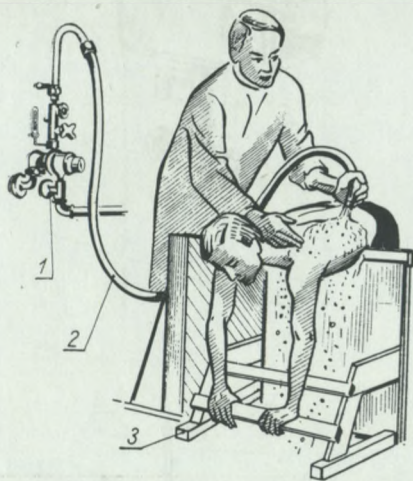
Rys. 7-10. Polewanie słodkowodne 1 — mieszacz wody, 2 — wąż natryskowy, 3 — stojak natryskowy
