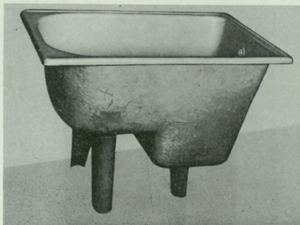
Rys. 7-61. Wanna do półkąpieli z tworzyw sztucznych produkcji krajowej Charakterystyka: wymiary 1070×690×750 (wys.) mm. Głębokość 585 mm i 385 mm, ciężar 14 kG, pojemność całkowita 195 l, do przelewu 155 l
