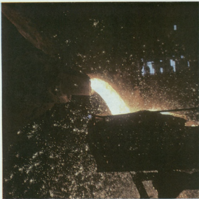
Nalévání surového železa do ocelářské pece
