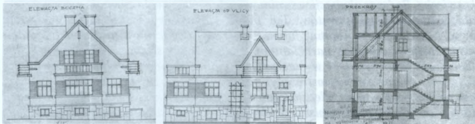
Projekt willi Anny i Alojzego Gałuszków wykonany przez Jana Hanusa. Widok elewacji frontowej (od strony wschodniej), elewacji bocznej (od strony południowej) oraz przekrój, 1936 r.
