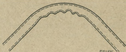
Rys. 90. Zniekształcenie cienkościennej rury podczas zginania
